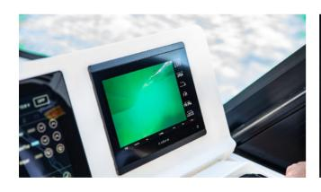
**ÉLECTRONIQUE & ACCESSOIRES**Caméra sous-marine sur le train d'atterrissage
